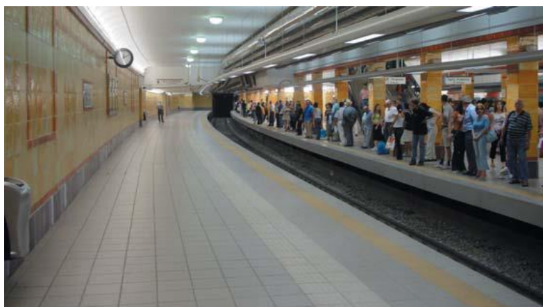
Figura 40 - Linea Metropolitana di Atene, ristrutturata in occasione delle Olimpiadi del 2004; per la pavimentazione delle banchine sono stati utilizzati gli elementi in grès porcellanato della serie Tactile di Casalgrande Padana.
